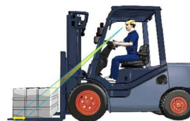
обзорность наконечников вилок и груза улучшена на 20 мм
